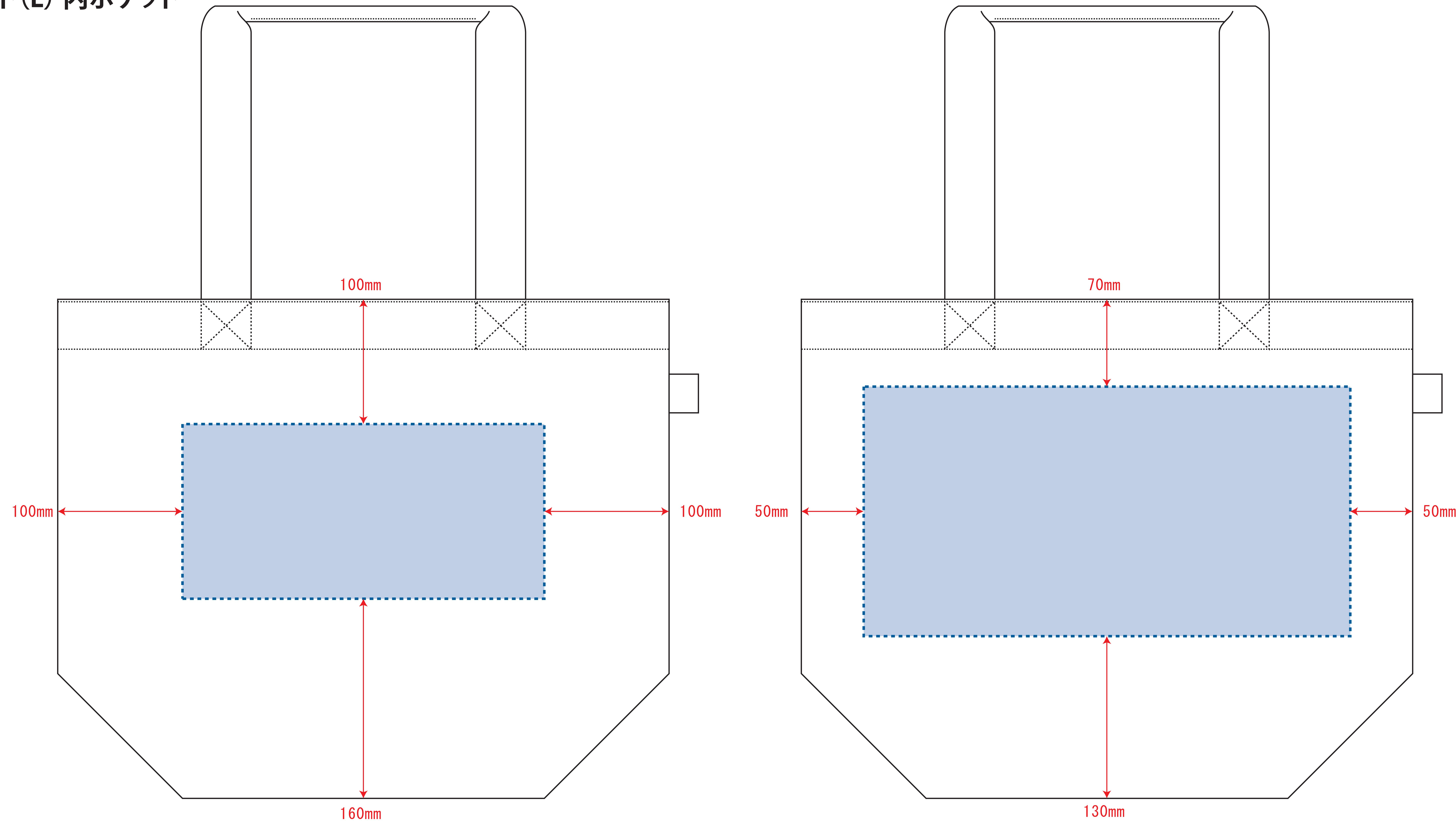
■最大範囲 :シリク・パッド・熱転写印刷:W290×H140(mm) インクジェット印刷:W390×H200(mm)
