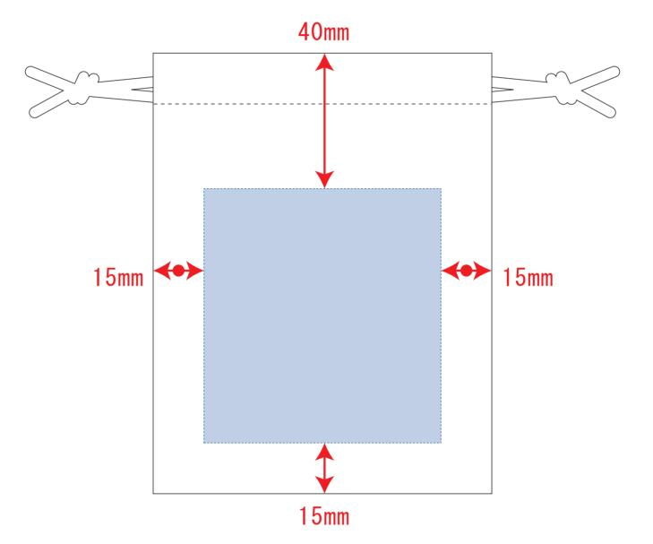
デザインスペース: W70×H75 (mm) ■ 熱転写印刷 最大範囲: W70×H75 (mm)
