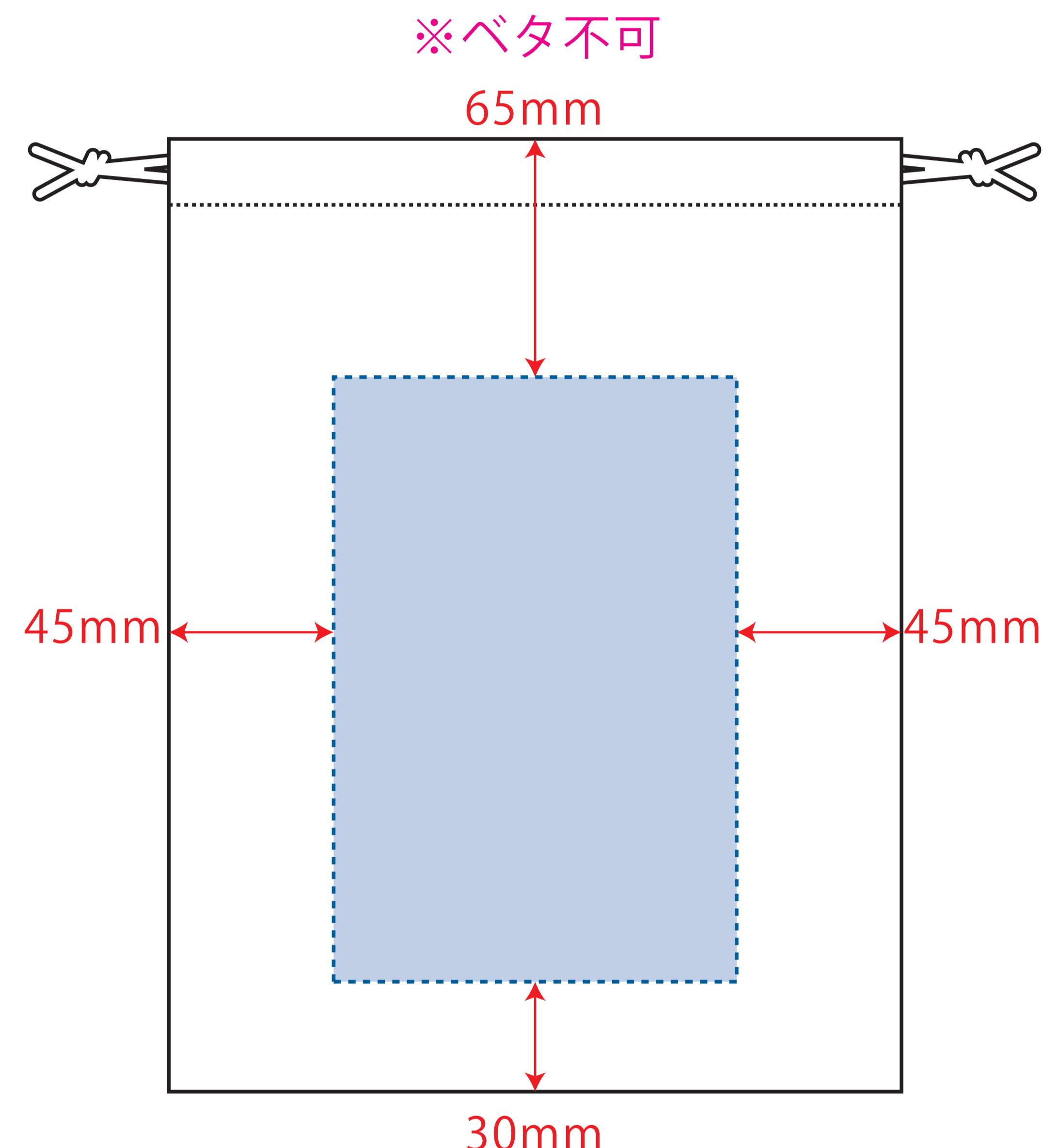
■ シルク・熱転写印刷 最大範囲 :W110×H165(mm)
