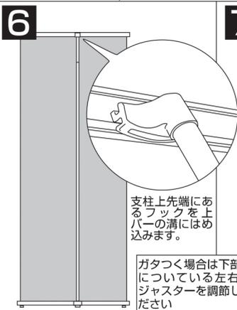
支柱先端にあるフックを上バーの溝にはめ込みます。
