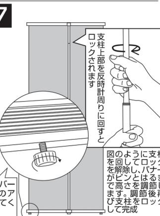
支柱上部を反時計回りに回すとロックされます。
