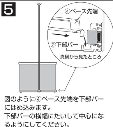
図のように④ベース先端を下部バーにはめ込みます。
